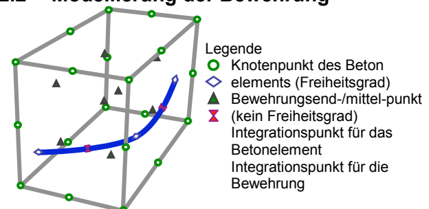
Bild 1 Eingebettete Modellierung der Bewehrung
